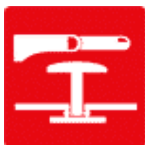
pulsante di sgancio elettrico generale
